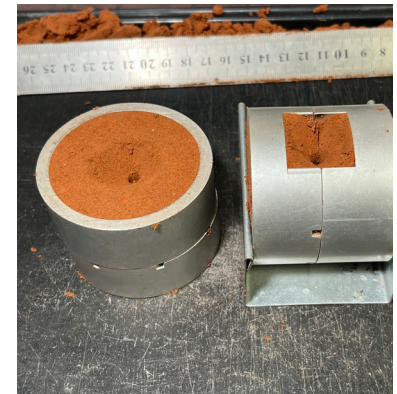
Top Pour and Side Pour Flasks
